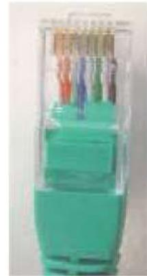
ケーブルの両端を同じ様に専用工具を使用して圧接
