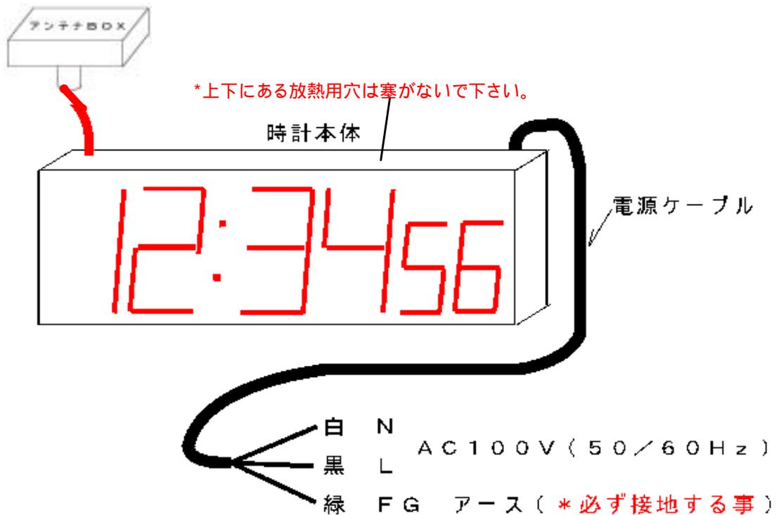
本体とアンテナBOXをアンテナケーブルで接続します。
